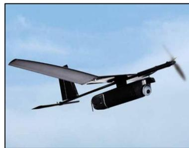
氢化镁燃料电池固定翼无人机
