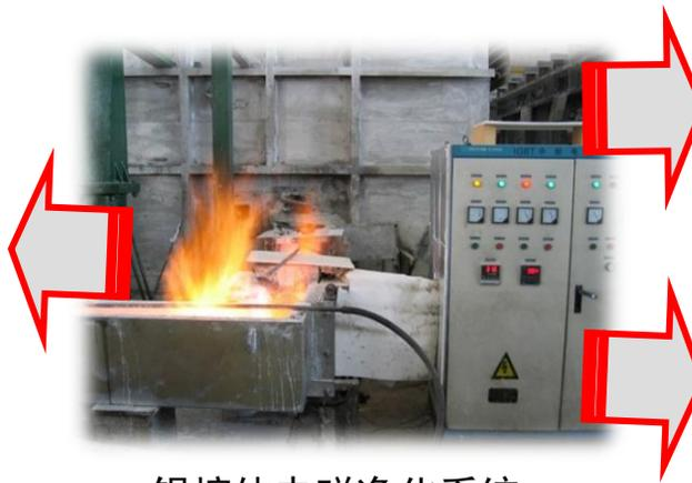
铝熔体电磁净化系统
