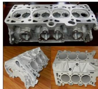
发动机缸盖/缸体
